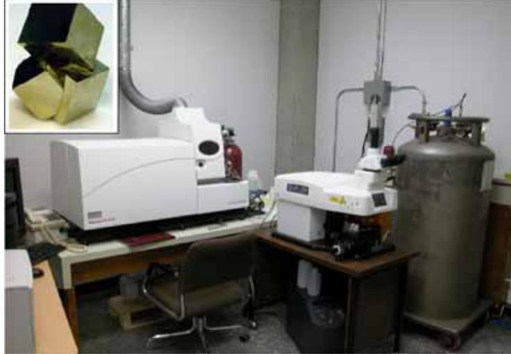
*Un nouvel appareil à la fine pointe de la technologie, le LA-ICP-MS, est utilisé pour établir les contenus d'éléments traces dans la pyrite.*
